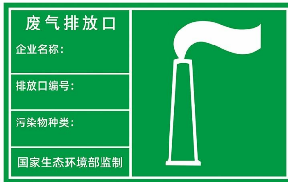
图 9.3-1 规范化废气排放口标志牌
