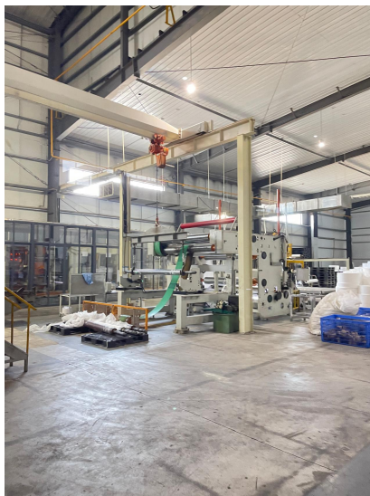
新增的纺熔（SMS）无纺布生产线（4 号线）
