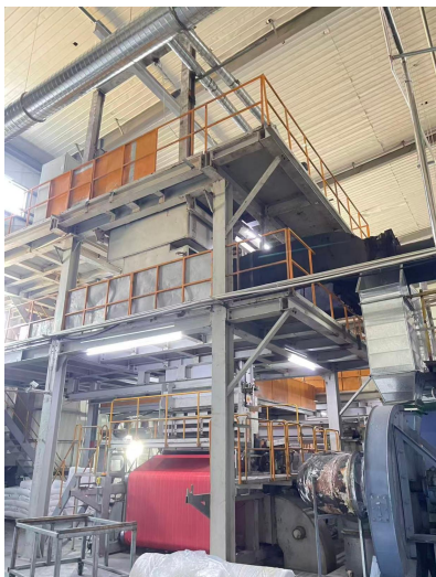
新增的纺熔（SMS）无纺布生产线（4 号线）
